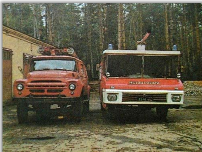
Прототип пожарной автоцистерны вагонного типа на укороченном самосвальном шасси автомобиля ЗИЛ-130 АЦ-40(130)-163 (1975 г.)
