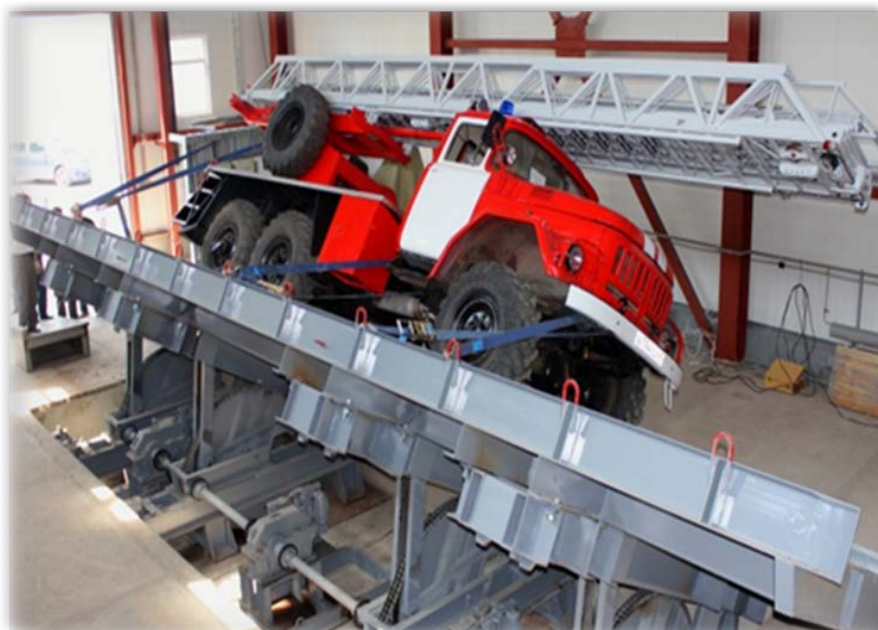
Стенд для определения поперечной устойчивости пожарных автомобилей
