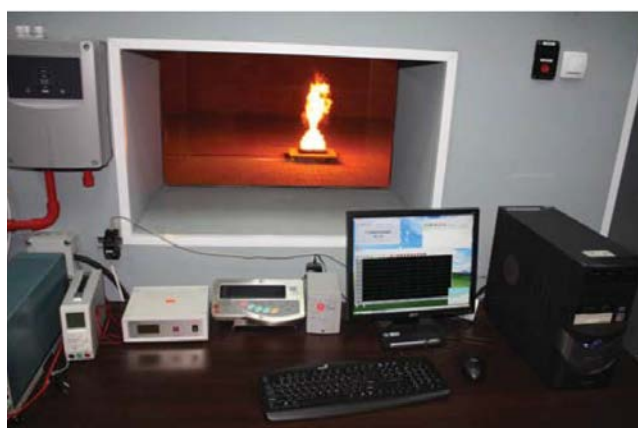
Исследование параметров тепловых и дымовых пожарных извещателей на стенде огневых испытаний
