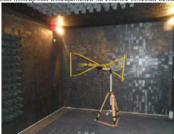
Проведение испытаний технических средств пожарной сигнализации на устойчивость к воздействию электромагнитного поля
