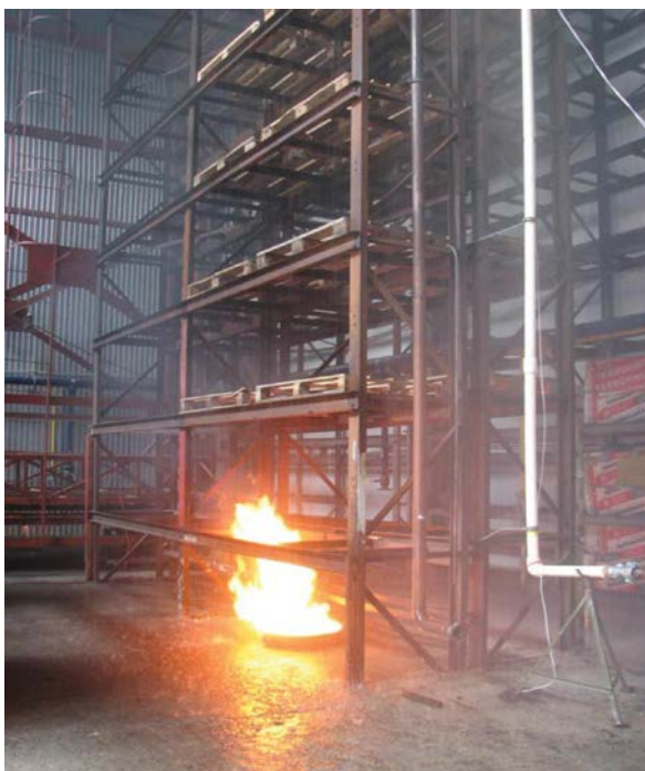
Огневые испытания системы пожаротушения стеллажных складов
